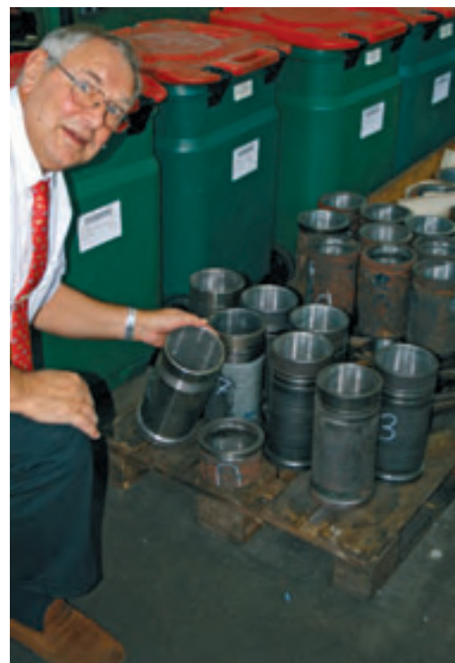
Karl-Friedrich Buck (63), Geschäftsführer der Carl Baguhn GmbH & Co. und stellv. Vorsitzender des Fördervereins, begutachtet die Laufbuchsen, die seine Firma nachgefertigt hat
